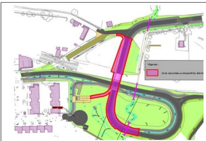
L'ensemble de ces eaux sera ensuite stocké et régulé dans une rétention enterrée située au Nord de la traversée de voie SNCF et dimensionnée pour permettre d'y stocker une pluie de temps de retour 30 ans avant rejet à débit régulé vers le ruisseau existant (fossé). Afin d'assurer le raccordement gravitaire de la rétention sur ce fossé, un remodelage ponctuel sera nécessaire.
