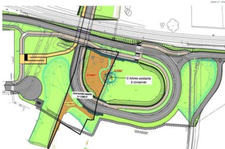
La zone humide restaurée **au sein de la boucle routière d'une surface de 648 m<sup>2</sup> et de 100 m<sup>2</sup>** est alimentée en eau par les noues de collectes des eaux de ruissellement issues des voiries ainsi que par le débordement du cours.
